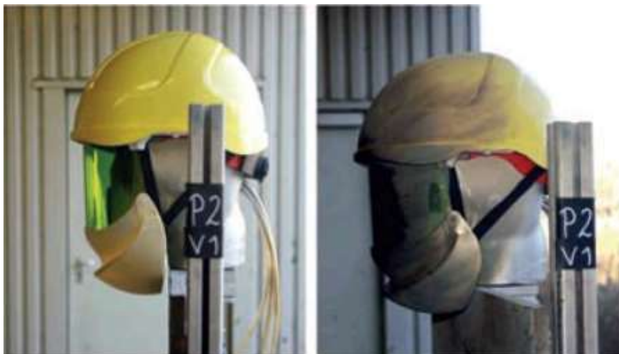
آزمون کلاه ایمنی برق با شیلد حفاظتی صورت با برند سکرا در مواجهه با قوس الکتریکی در محیط آزمایشگاه
